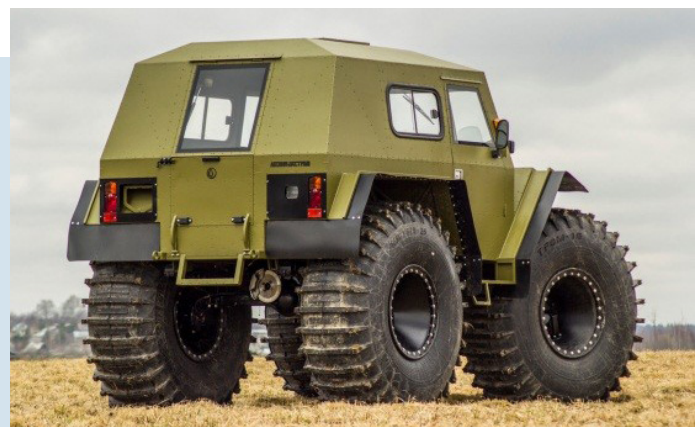
Вездеход «Лесник» с шинами «Тром-16»
